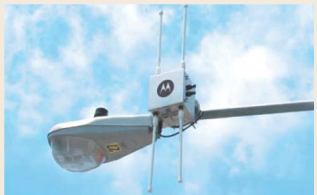
Spröder Industriecharme: Bei Outdoor Access Points kommt es vor allem auf Robustheit an – als Beispiel der Mesh Wireless Router MWR6300 von Motorola (Abb. 2).
